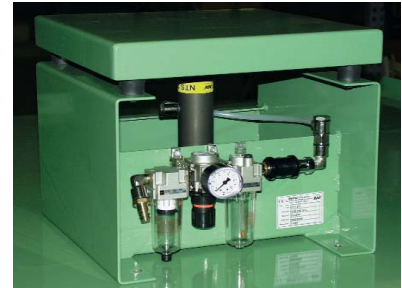
Вибрация и уплотнение различных материалов в картонных коробах
