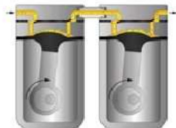
1. Конденсат снижает производительность насоса
