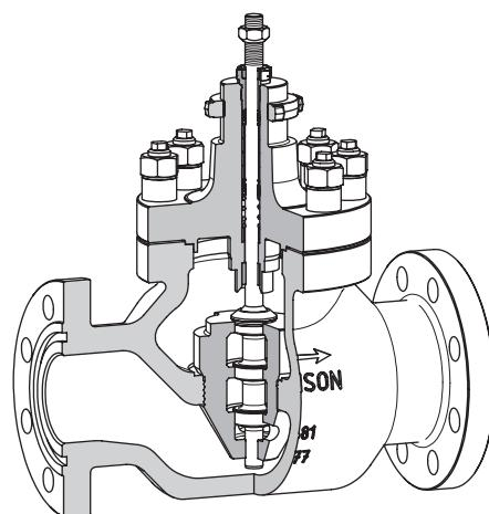
Рис. 1 · Проходной клапан тип 3251 с гарнитурой АС-3
